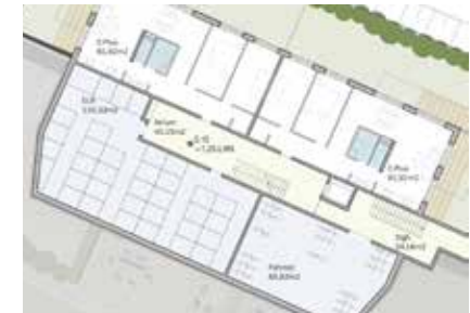
8. Bauteil 2: Einlagerungsräume im EG, Zugang vom Stiegenhaus
