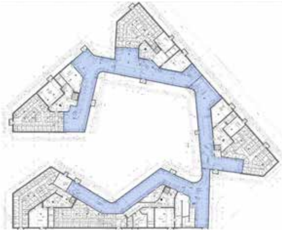
13. Ringförmige Fahrradtiegarage im UG
