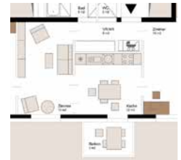
17. Anordnung der Balkone vor dem Wohn-/Ess-/Kochbereich
