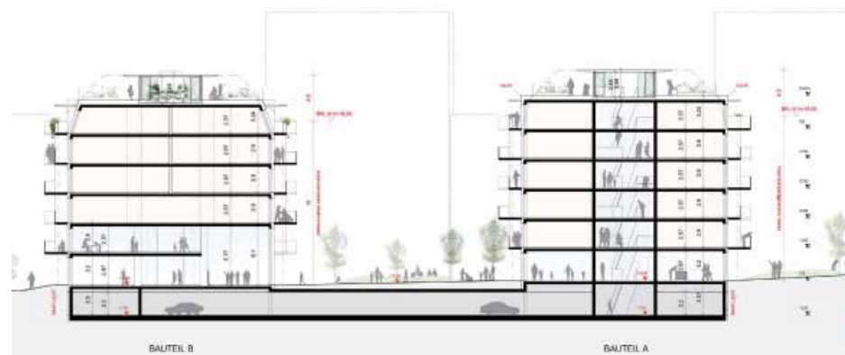
31. Querschnitt beider Gebäude mit zentralem Freiraum
