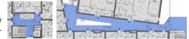
22. Bauteil C – Deckendurchbrüche in allen Geschoßen, natürlich von oben belichtet (links)
