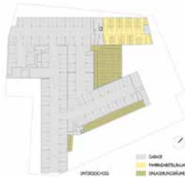
11. Tiefgarage, Einlagerungs- und Abstellräume im UG
