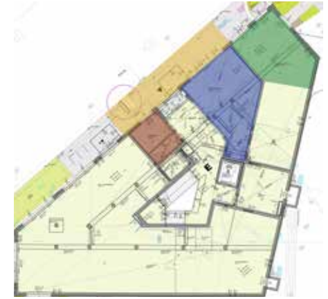
23. Eingangsbereich mit Gemeinschaftsraum (blau), Spielraum (grün), Hausbetreuungsbüro (rot) und Erweiterung des Foyers in Richtung Straßenfreiraum (orange)
