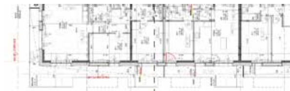
25. Umlaufendes Loggienband mit auskragenden Balkonen
